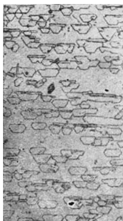
Abbild. Orientierte Aufwachsung von Anthracen auf (001) von Chloranil. Vergr. 225-fach.
